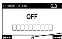
Indica que o humidificador não está funcional devido à ligação à bateria.
